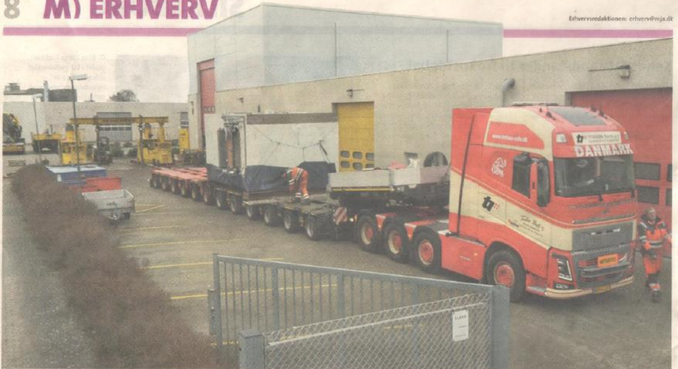
○ Lastbilen fik mandag læsset den enorme, hydrauliske presser på traileren. Maskinen fra Kuni vejer 125 ton og kan presse op til 3800 ton. Den store presser er fem meter høj og måtte transporteres liggende. FOTO: KUNI MASKINFABRIK
